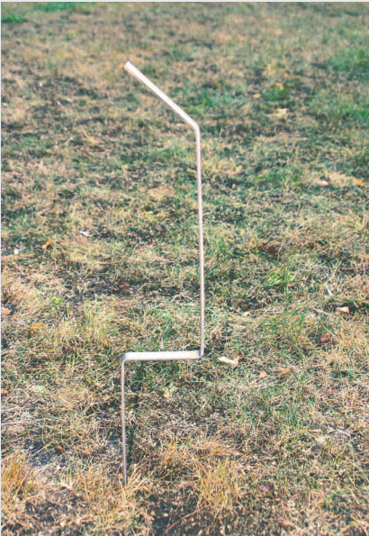
Haltepfosten, feuerverzinkt mit Spitze, senkrechte Länge 30 cm, Überhang 10 cm, Laufstraße 10 cm, Länge im Boden 35 cm. Support post, galvanized. Height 30 cm (vertical), plus 10 cm overhang. Walking path 10 cm. Depth in ground 35 cm.
